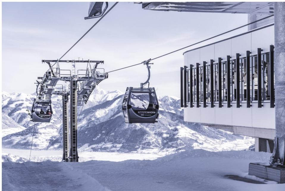
Снимка 2. Един от многото новоинсталирани кабинкови лифтове през последните години, които разполагат с подгряване на седалките чрез соларни панели, както и система за видеонаблюдение (на глетчера Kitzsteinhorn)
